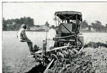
Deere's Schijvenploeg, getrokken door een 75 P.K. Caterpillar Tractor.
